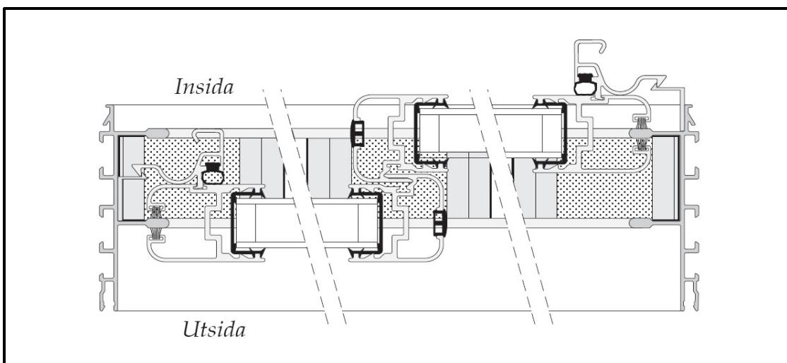
10. Montera den bifogade kondenslisten på bottenprofilens insida. Tips! Täta med silikon i kondenslistens spår innan den slås fast. Täta även kondenslistens ändar mot vägg.
